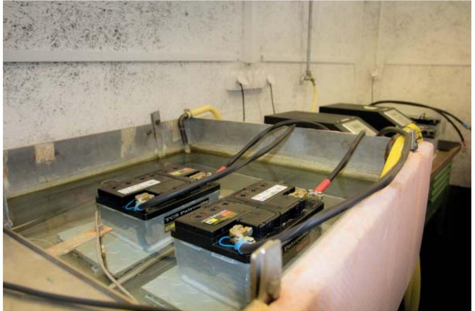
Nel bagno d'acqua le temperature prescritte per il test batterie vengono tenute costanti.
