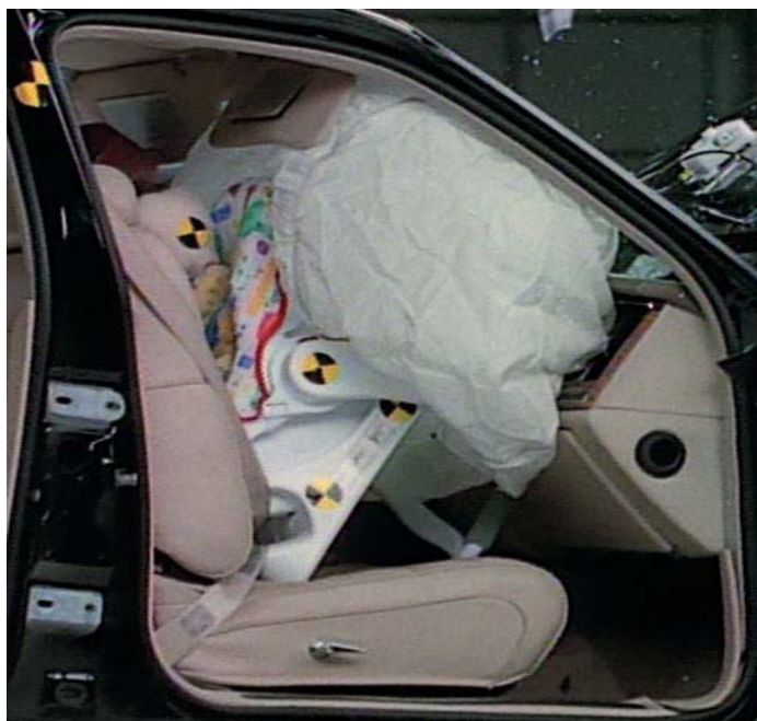
Seggiolini in direzione contraria alla marcia sul sedile passeggero anteriore: pericolo mortale in caso di attivazione dell'airbag.
